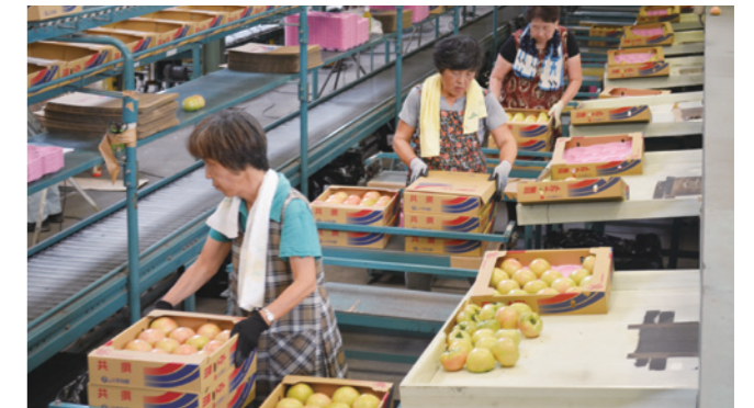
▲汚れや傷を見た後、機械で自動で大きさ選別していきます。
